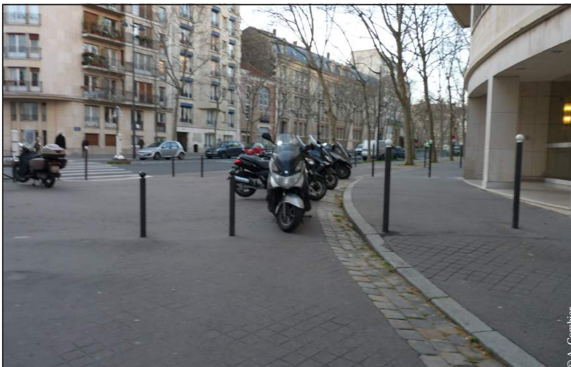
Un trottoir à Paris dans le 7 e - Où se trouvent les limites de ce trottoir, et comment est-il partitionné ? Les piquets font partie des éléments urbains qui peuvent heurter la circulation des personnes malvoyantes.
